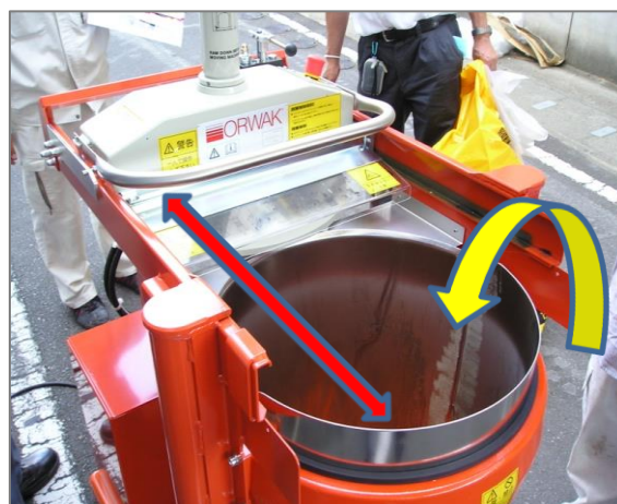
上部よりアスベストを投入 上部ユニットを締め、圧縮→2~3回繰
