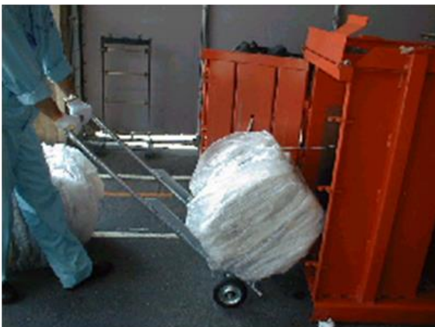
専用カートで取り出し保管場所へ移動
