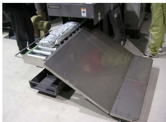
溶融インゴットは、自動排出 & 自動切断
