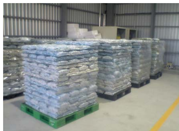
溶融インゴットは板状なのでパレット等に 積み重ねやすく保管性に優れている
