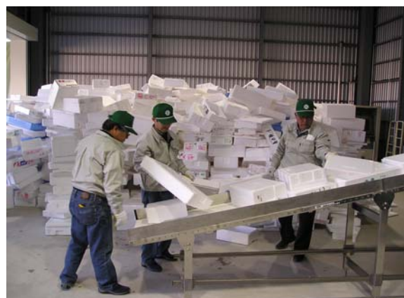
搬送ベルトにて破碎部へ投入
